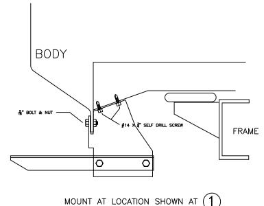
DRILLING INTO VEHICLE IS REQUIRED
